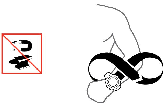
Proběhla-li kalibrace úspěšně, zobrazí se text **CALIBRATION SUCCESSFUL** (Kalibrace úspěšná). Nebyla-li kalibrace úspěšná, zobrazí se text **CALIBRATION FAILED** (Kalibrace selhala). Chcete-li kalibraci zopakovat, stiskněte [Start Stop].
