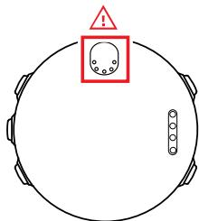
**⚠️ UPOZORNĚNÍ:** Udržujte místo okolo senzoru bez nečistot a písku. Nikdy nevkládejte žádné předměty do otvorů senzoru.
