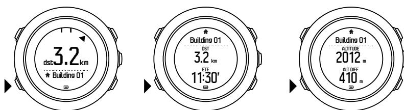
Když stojíte nebo se pohybujete pomalu (< 4 km/h), hodinky ukazují směr k POI (nebo waypointu, pokud navigujete po trase) podle azimutu na kompasu.
