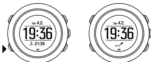
Indikátor tendence počasí se skládá ze dvou linek tvořících šipku. Každá linka představuje tříhodinový časový úsek. Změna tlaku vzduchu překračující 2 hPa (0,59 inHg) v průběhu tří hodin vede ke změně směru šipky. Například:
