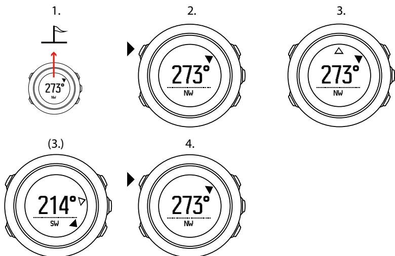
**POZNÁMKA:** Když používáte kompas během záznamu aktivity, tlačítko [BACK LAP] pouze aretuje azimut a ruší jeho aretaci. Chcete-li změřit mezičas tlačítkem [BACK LAP], musíte opustit zobrazení kompasu.
